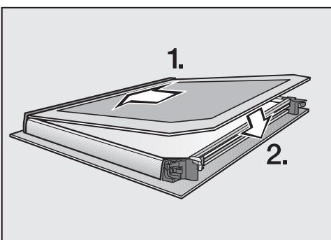
■ Gurnite unutarnju ploču vrata, s mat stranom okrenutom prema dolje, u plastičnu letvicu i postavite unutarnju ploču vrata između blokada.
